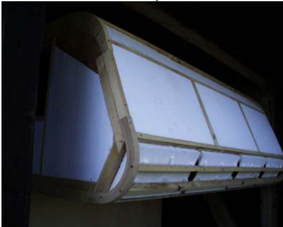
Das gleich von hinten. Rückwand aus 9mm Sperrholz, damit der Fahrradträger nicht abfällt
